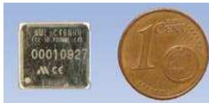
**Abbildung 8: Größenvergleich Bluetooth-Sender,**
